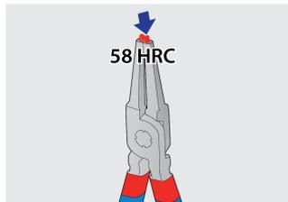
vrhovi su kaljeni do tvrdoće od 58 HRC da bi se sprečilo savijanje ili lom vrhova pri montaži ili demontaži seger prstenova
