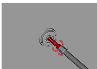
prvo postavite izvlakač kroz otvor ležaja koji treba demontirati sa kućišta. Zatim počnete da zavijate trn, koji ima funkciju da otvori telo izvlakača tako da se prilagodi veličini otvora ležaja.
