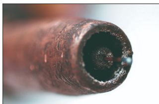
uklanjanje nečistoće i ostataka vara sa i iz unutrašnjosti mlaznice
