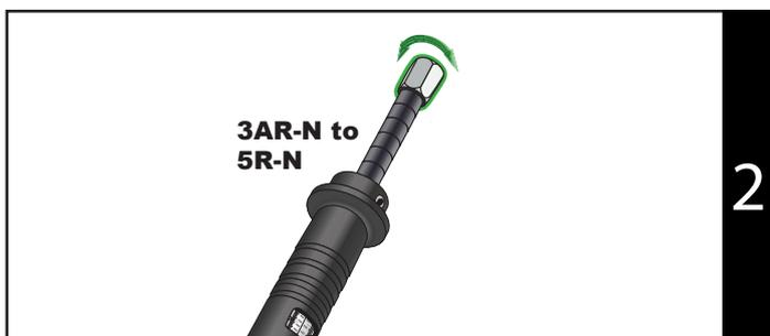
Turn nut to adjust • Tournez l'écrou pour effectuer le réglage • Schlüssel durch Drehen der Skalenspindel einstellen • Girare il dado per effettuare la regolazione • Girar la tuerca para ajustar
